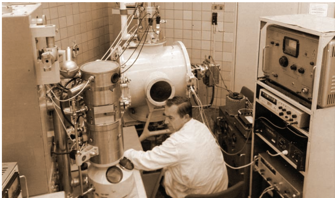
Рис. 4. Установка ЭЛМЭЛГ для исследования структуры молекул методом газовой электронографии
