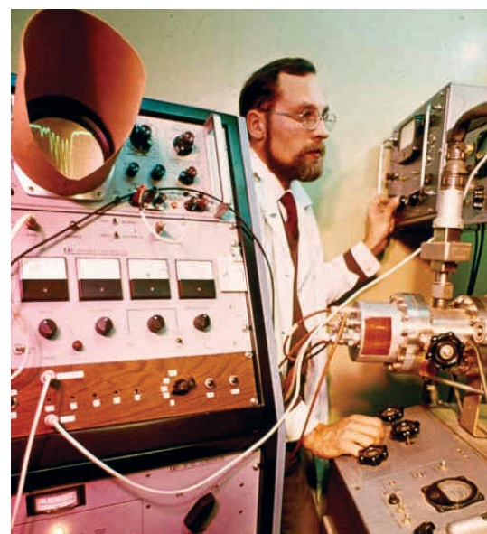
Рис. 3. Масс-спектрометрическая установка «Дефлектрон» с неоднородным магнитным полем для разделения диа- и парамагнитных составляющих молекулярного пучка
