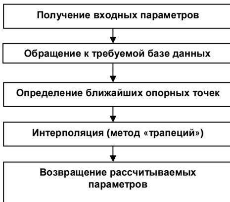
Рис. 1. Алгоритм работы простейшего обработчика
