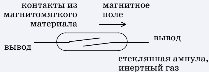
Рис.П4.1.1. Конструкция геркона
