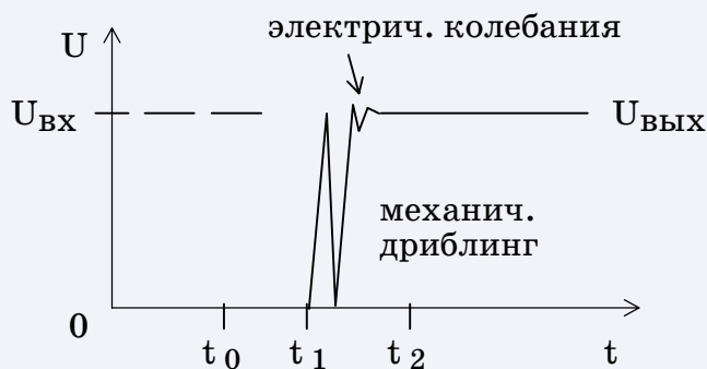
Рис.П4.1.2. Инерционность релейного коммутатора
